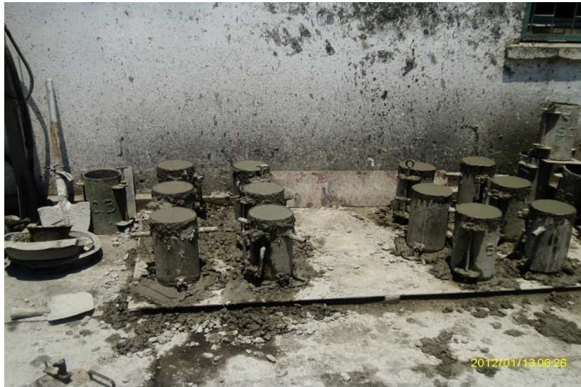
Photo 2 : Moules cylindriques en acier rempli du BFL
