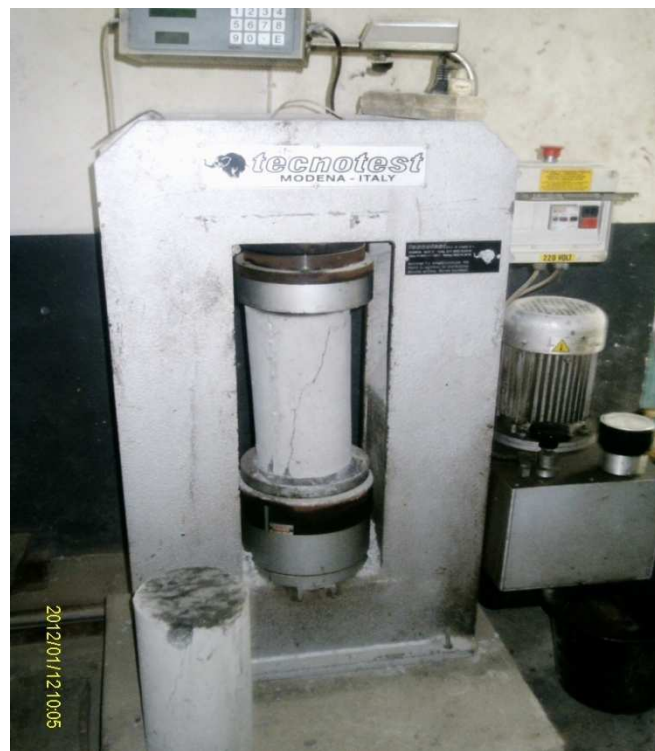
Photo 4 : Essai de compression des éprouvettes cylindriques du BFL
