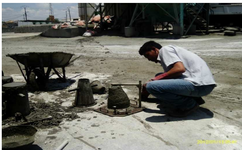
Photo 1 : Test à l'affaissement au cône d'Abrams du BO
