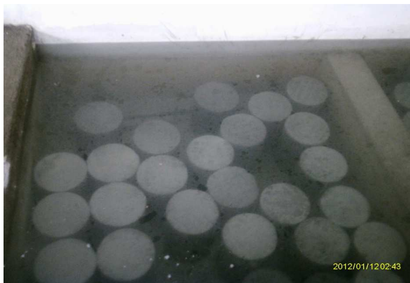
Photo 3 : Bac remplie d'eau contenant des éprouvettes cylindriques 16 *32 cm
