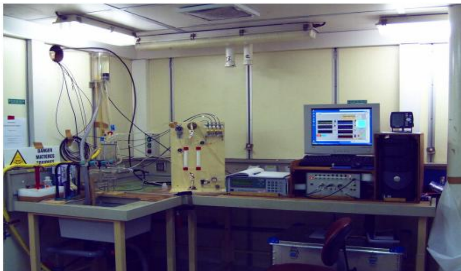
Figure 15 : Dispositif de mesure de la fugacité \text{CO}_2 (Source LOCEAN – Archives Photos - Nathalie Lefèvre)
