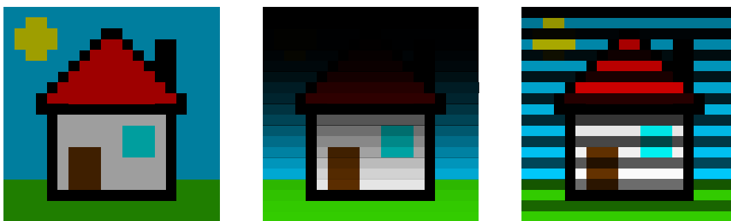
FIGURE 1.4 – Illustration de l'entrelacement. (a) Image originale. (b) Image affichée par un balayage progressif de l'écran. (c) Image affichée par un balayage entrelacé. La différence de luminosité est moins gênante dans le cas d'un affichage entrelacé, la finesse des lignes permet à l'observateur de ne pas percevoir le clignotement des lignes. Dans le cas d'un affichage progressif, le clignotement est perceptible car il implique une grande partie de l'image.
