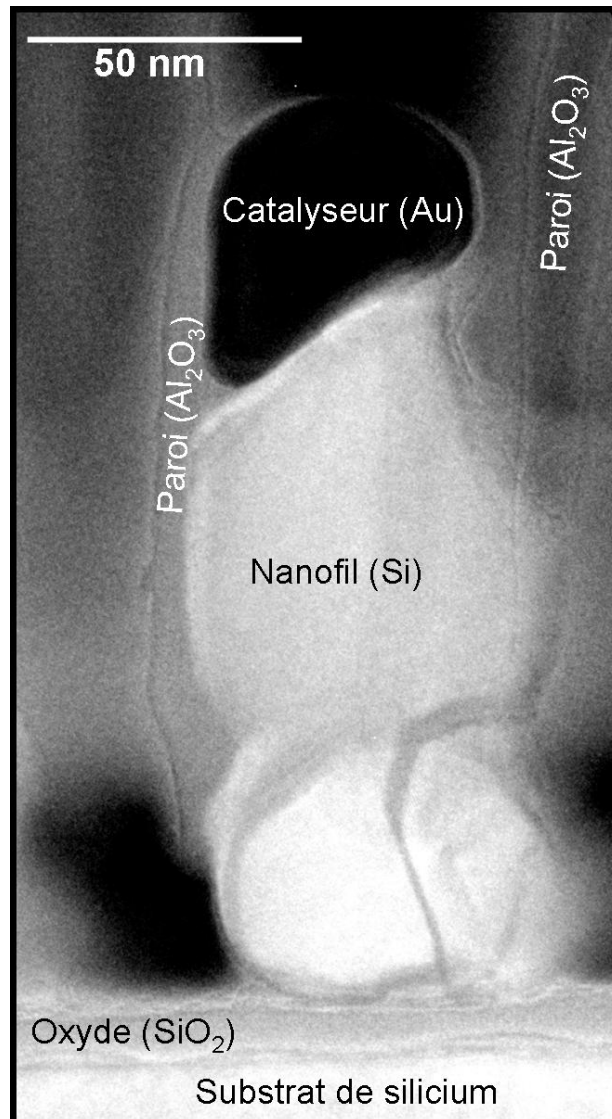
Fig. 4.28: Image MET d'un nanofil de silicium crû dans l'alumine à partir d'un colloïde d'or. La couche d'oxyde, les parois d'alumine et le catalyseur d'or sont bien visibles. ( Image réalisée par Martien den Hertog (Lemma) ).
