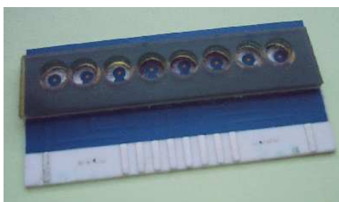
Figure 1.10 : Photographie de huit capteurs LAPS multiplexés (courtoisie de Pohanka)
