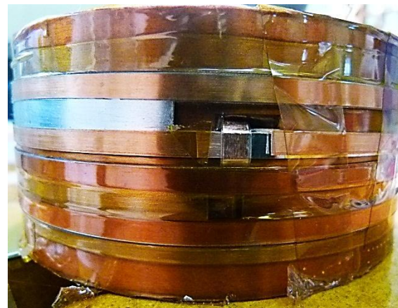
d- Bobine avec les jonctions
