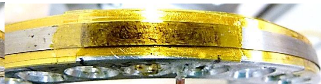
14- Ajout d'un ruban de Kapton localement au niveau du lap joint pour réduire la dissipation thermique dans l'air.
