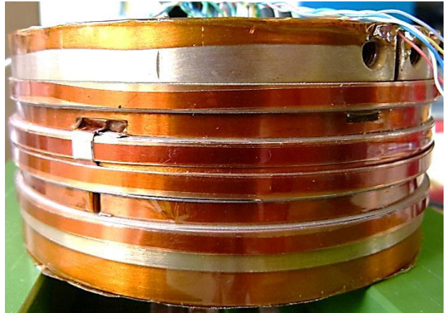
10- Bobine avant les jonctions
