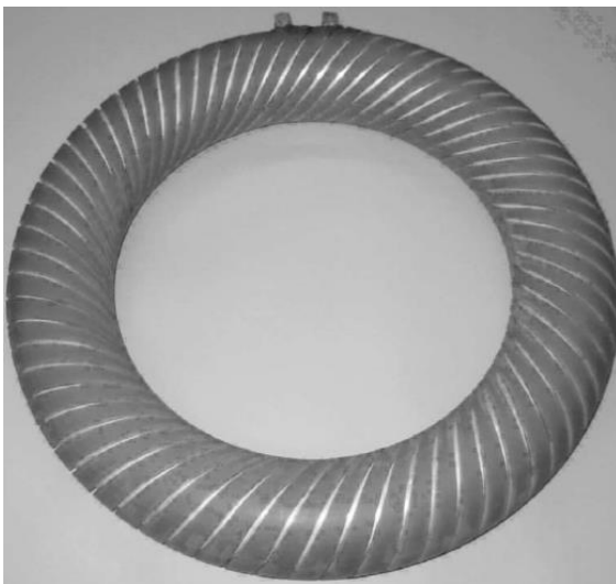
Figure 1-25 : Configuration toroïdale en hélice avec des efforts compensés [18].
