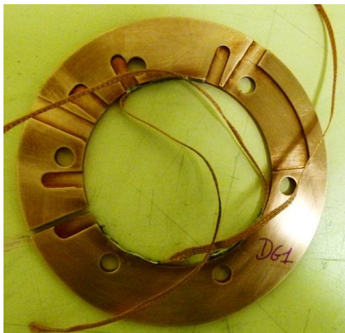
c- Plaque de cuivre de refroidissement
