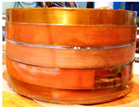
e- Bobine finale avec les jonctions
