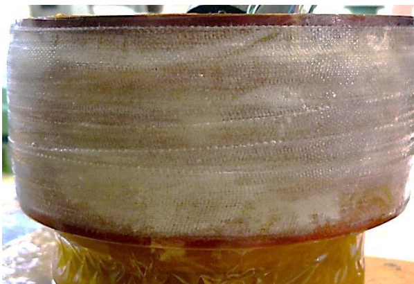
13- Bobine HTS2 après imprégnation fibre de verre
