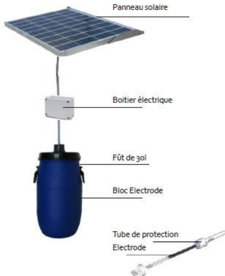
Figure 6 : Illustration d'un modèle d'unité de PAC
