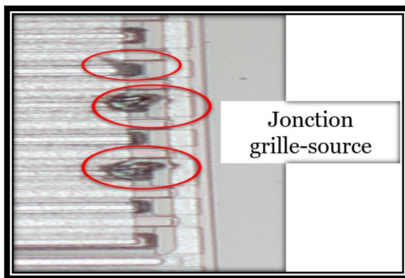
Figure 113: Défaillance observée après stress TLP sur totems pole en SiC.
