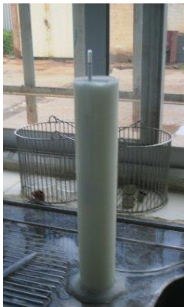
Figure 11: mesure de la densité par lactodensimètre
