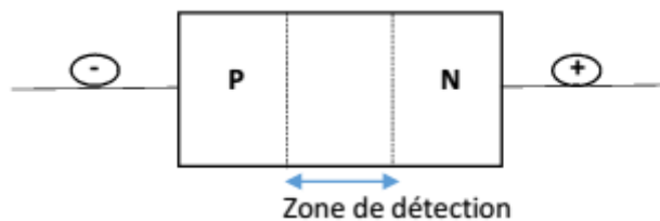
Figure 13 : Schéma simplifié d'un détecteur à semi-conducteur [1]
