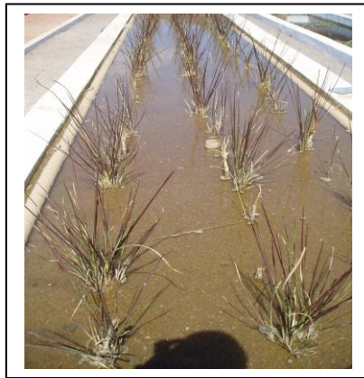
Figure n°16 : Filtre phytologique à Vétiver
