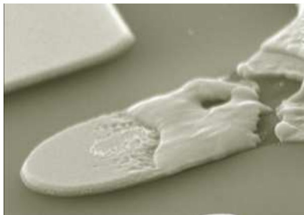
Figure 1.24 Microscopie de micro-commutateur défaillant (Yan et al. 2000)
