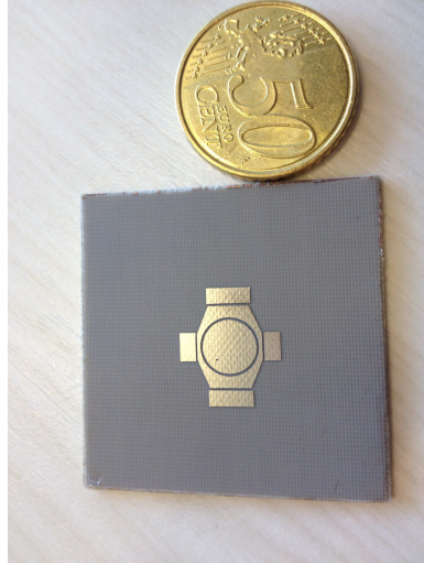
Figure 6.4 – Photo de l'antenne avec quatre parasites
