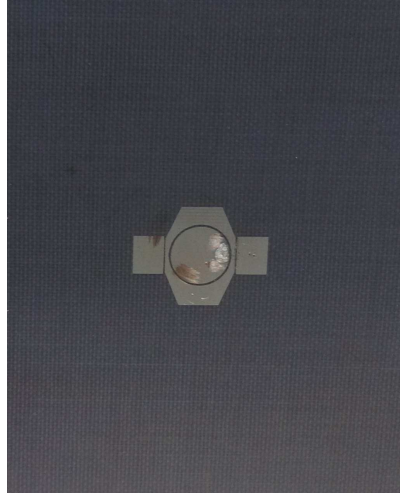
Figure 3.40 – Antenne avec rectangles parasites sur les côtés
