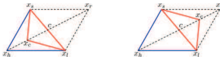
FIGURE 1.4 – Opération de contraction interne (à droite) et externe (à gauche) du simplexe
