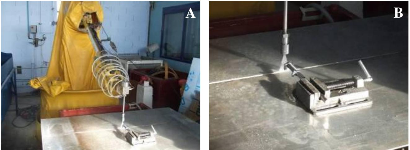
**Figure 31 : A : Robot à tête 5 axes avec buse à jet plat ; B : Détail du jet, du filtre et de l'eau**
