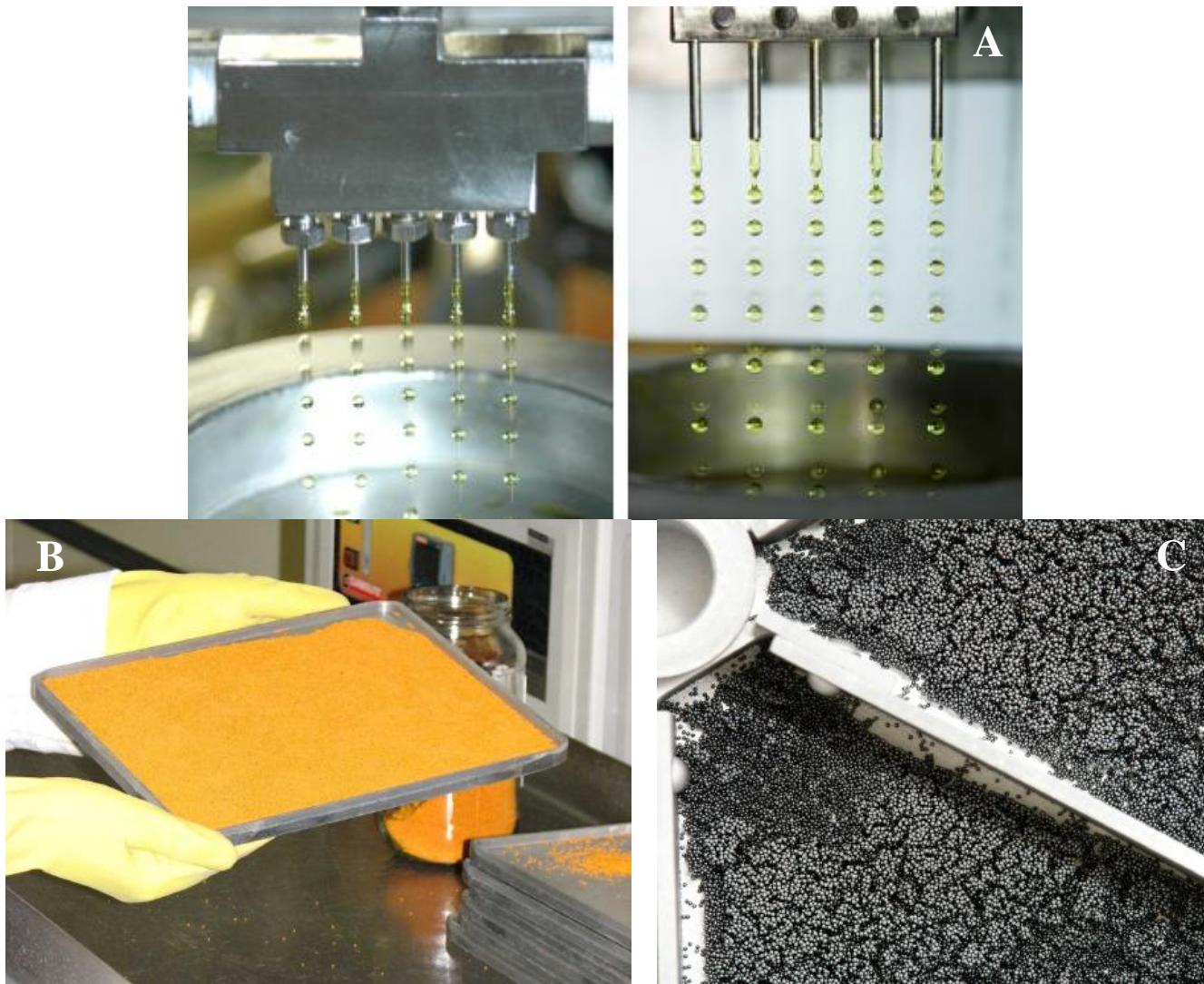
**Figure 6 : A : Formation de gouttes dans le procédé de fabrication des kernels au Kernel Laboratory de PBMR ; B : Kernels de ADU avant calcination ; C : Kernels frittés d'UO<sub>2</sub>**
