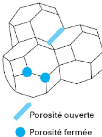
**Figure 112 : Grains schématisés par des cuboctaèdres tronqués mettant en évidence les deux types de porosité**
