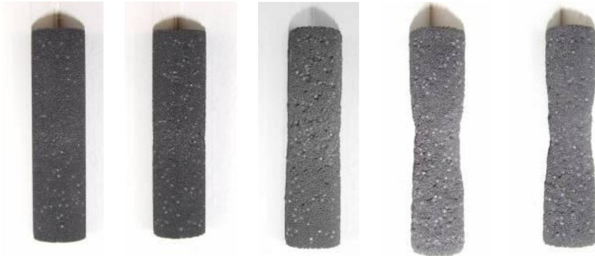
**Figure 55 : Photographies du compact à 10 % érodé après 2 ; 4 ; 9 ; 14,75 et 17,5 h**
