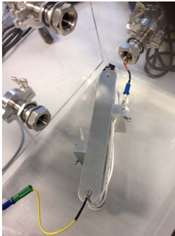
Figure II- 9: Support de vieillissement portant le câble introduit dans l'enceinte étanche pour mesures de décharges partielles
