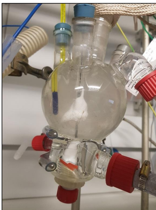
Figure 3.14 – Formation d’une coquille d’alumine BT0 autour de l’électrode haute tension
