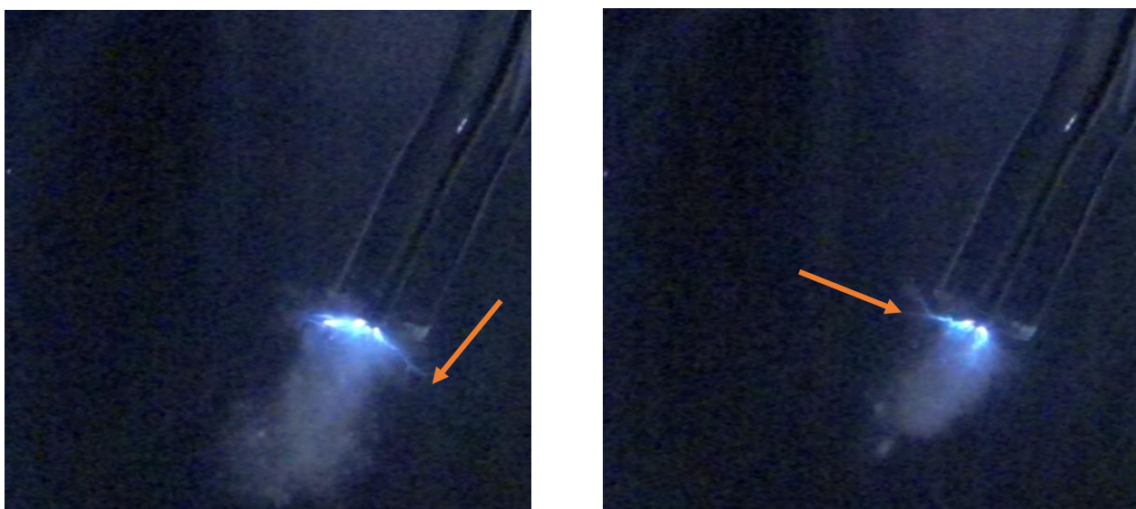
Figure 3.1 – Propagation de la décharge dans le milieu liquide (éthanol) sous forme de streamers (marqués par des flèches). Un panache de bulle est également visible.
