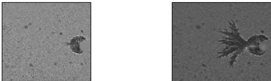
Figure 2.9 – Propagation du plasma dans le liquide sous forme de filaments de plasma ( streamers ) [105].
