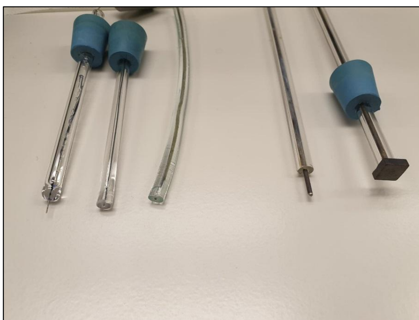
Figure 2.12 – Différentes électrodes utilisées au cours de la thèse. De gauche à droite électrode haute tension point en tungstène ; électrode haute tension disque en tungstène ; électrode haute tension disque en fer ; électrode de masse en inox tige ; électrode de masse en inox carrée.
