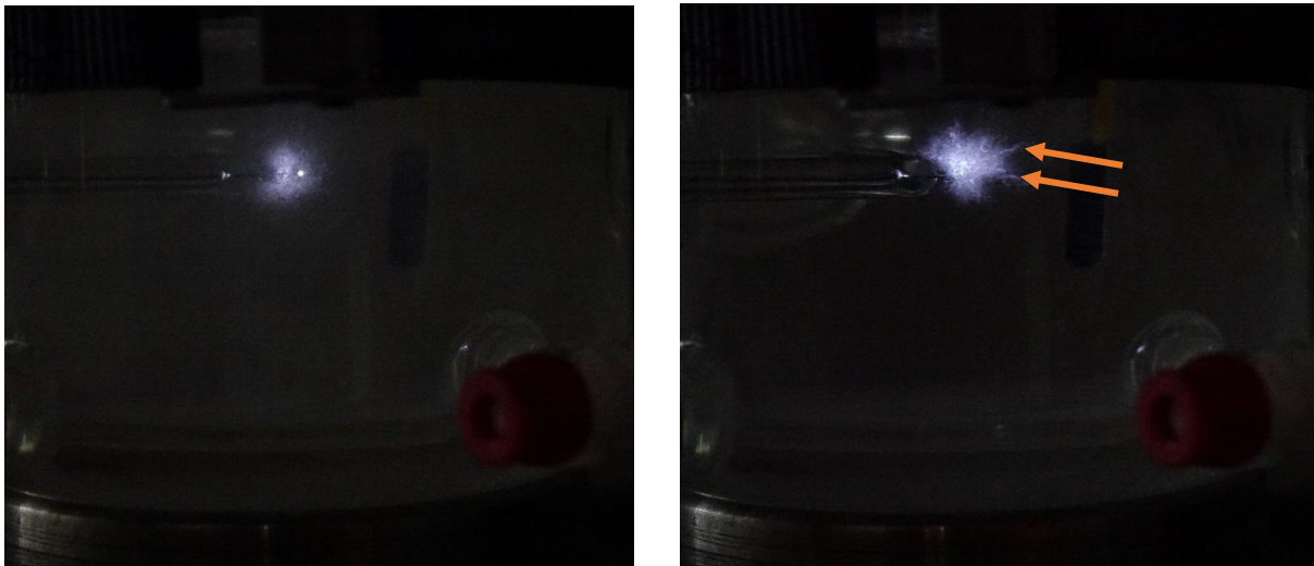
Figure 3.22 – Propagation de la décharge dans le milieu liquide lors de l’injection de l’hélium à gauche et suivie par l’explosion du gaz injecté sous forme de streamers (marqué par des flèches) à droite.
