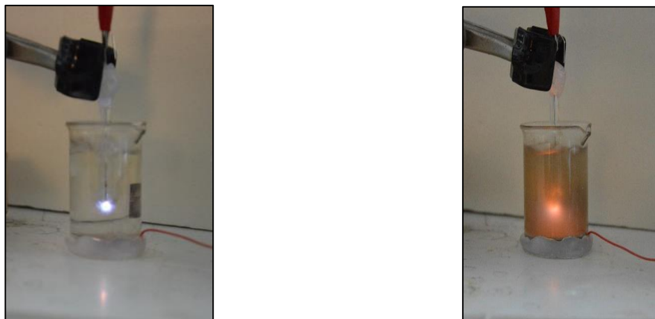
Figure 2.4 – A gauche, décharge plasma dans l’éthanol sans solide, à droite décharge avec ajout de particules d’oxyde de magnésium (0,25 g dans 50 ml)
