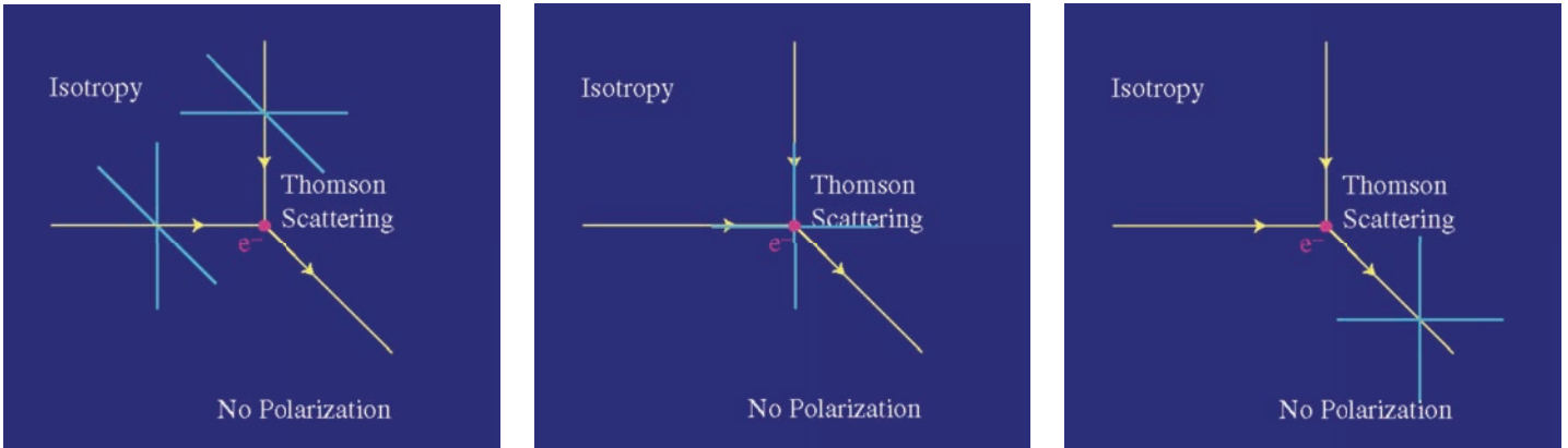
FIGURE I.24 – Même raisonnement que pour la figure I.23 mais avec deux photons non polarisés identiques arrivant perpendiculairement l'un par rapport à l'autre sur l'électron libre. Après diffusion, le photon de gauche ne portera que la composante verticale du champ électromagnétique tandis que celui du haut ne portera que la composante horizontale. Au final, la combinaison observée n'est pas polarisée. Cela se comprend mieux en remplaçant désormais les photons par des flux de photons non polarisés identiques.
