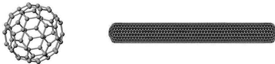
FIG. A.1 – A gauche, molécule de fullerène C_{60} , à droite : nanotube de carbone monoparoï fermé de chaque côté.
