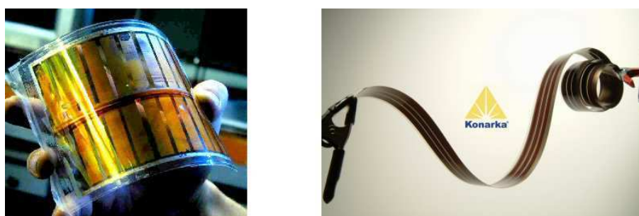
FIG. 1.15 – A gauche : cellule solaire à base d'un dérivé du PPV et de fullerène conçue par l'équipe de S. Sariciftci ; à droite : cellulaires solaires sous forme de rouleaux développées par la société Konarka.
