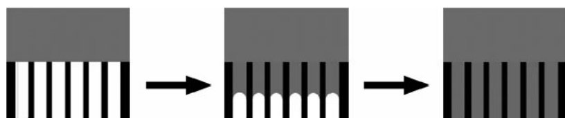
FIG. 2.43 – "Infiltration by capillarity wetting" d'une membrane de polycarbonate : imprégnation du polymère en solution ou sous forme liquide gouvernée simplement par les forces de capillarité [163].
