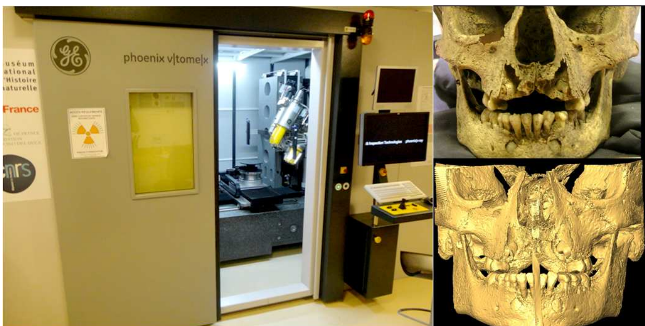
Figure 12. Scanner microtomographique à rayon-X de la plate-forme AST-RX du Muséum national d'Histoire naturelle de Paris (à gauche), individu Chumash sélectionné (en haut à droite) et le même spécimen après examen microtomographique, avec acquisition centrée sur le complexe maxillo-mandibulaire (en bas à droite)
