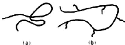
Figure 100 : Représentation schématique des molécules polymères : (a) linéaire (b) ramifiée 68
