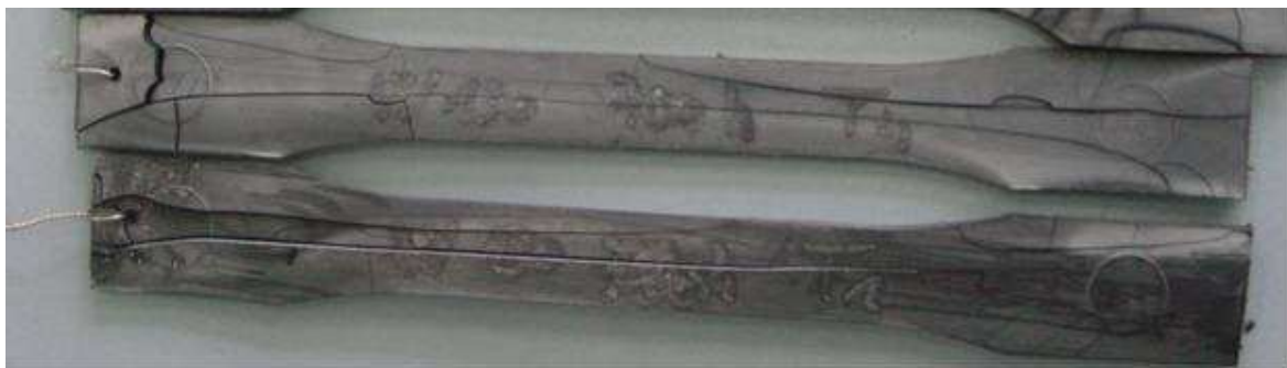
Figure 61 : Photographie de PA66 après 700 heures de vieillissement dans l'eau à 130°C
