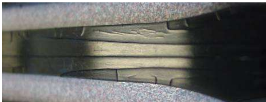
Figure 75 : Photographie de PA66 après 850 heures de vieillissement dans le glycol à 130°C
