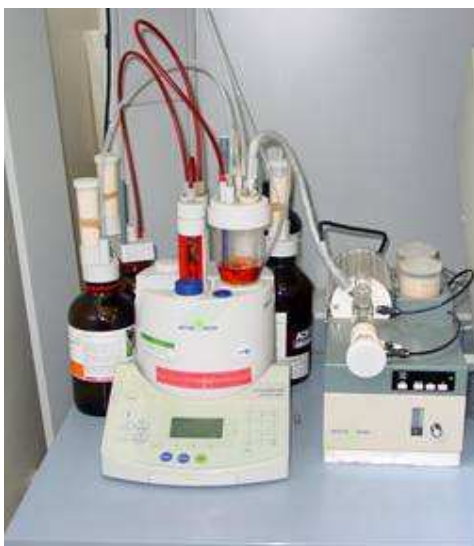
Figure 37 : Photo du dispositif Karl-Fisher avec le four permettant la chauffe de l'échantillon (à droite) , les bouteilles contenant la réserve de solvants et réactifs et le titrateur
