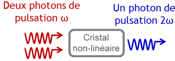
Figure 3.1 : Principe du doublage de fréquence
