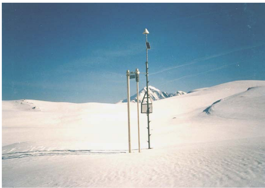
Figure II-3 Télénivomètre EDF situé au Lac Noir
