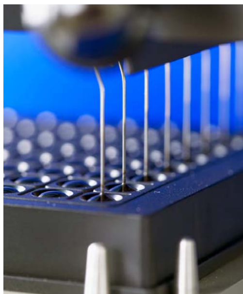
Figure 1.18 : D'après [133]. Photographie du système Kibron CM Ceecker pour le criblage pharmacologique à haut débit.
