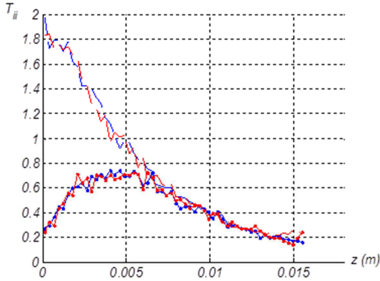
Figure 91 : Cas A ( d_p = 1.10^{-5} m, plan L_z/6 ) : Échelle temporelle de décorrélation lagrangienne des particules suivant (tirets --) : les vitesses parallèles à la surface libre, et (points et tirets ._) : la vitesse normale à la surface libre). (Bleu) : ( \rho_p/\rho_f = 1 ) sans sédimentation, (Rouge) : ( \rho_p/\rho_f = 0,5 ) avec sédimentation
