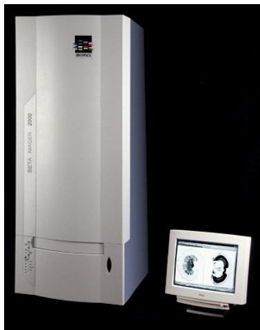
Figure 4.7 : Photographie du radio-imager : le \beta -imager 2000 de la société Biospace.
