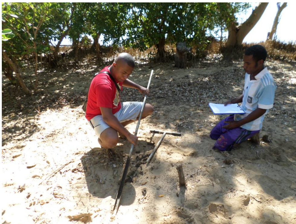
Figure 21 : Le montage de la tarière manuelle pour le prélèvement des échantillons de sol. (Andriatsiaronandroy, 2018)
