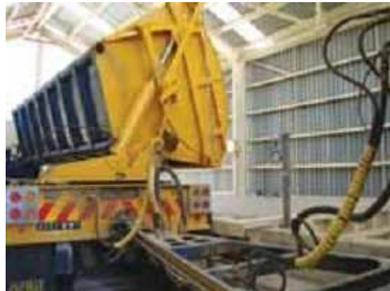
Photos 4. Auto-basculement de la remorque pour le déchargement d'ilménite au port.
