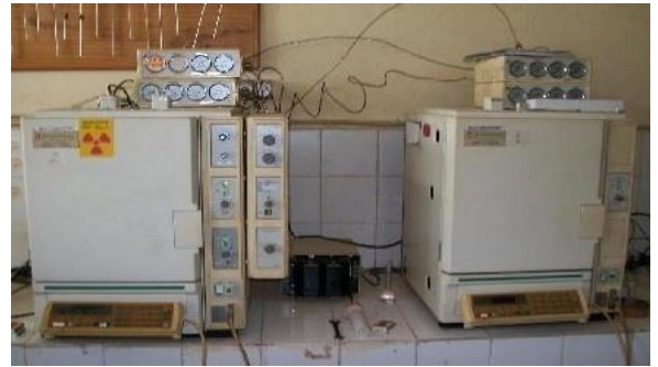
Photo 7 : CPG muni d'un détecteur à ionisation de flamme
