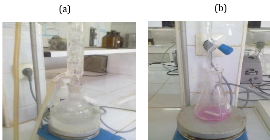
Photo 5 : (a) Montage pour la réaction de saponification (b) titrage
