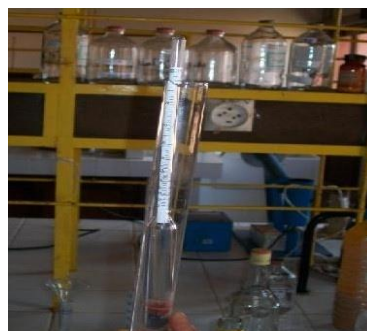
Photo 1.b: Mesure du degré de l'alcool avec un alcoomètre
