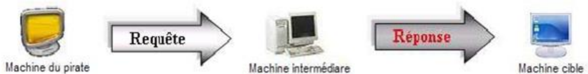
Figure 2.03 : Principe de l'attaque indirecte par réponse
