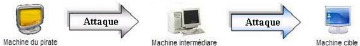
Figure 2.02 : Principe de l'attaque indirecte par rebonds
