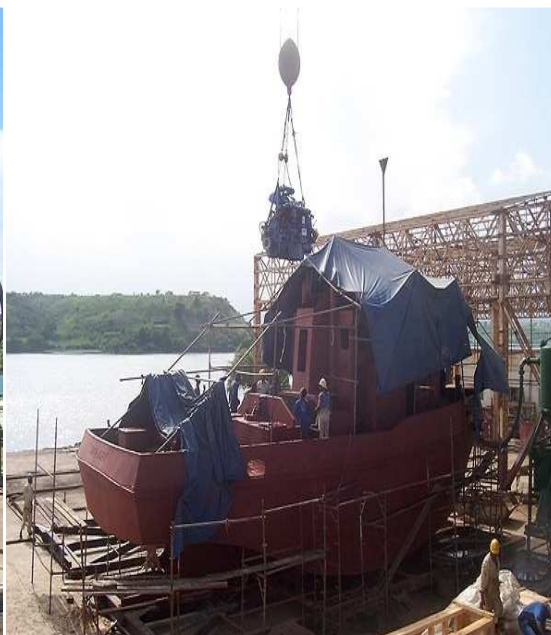
Construction de la vedette JAOLAHY 2-Montage de moteur
