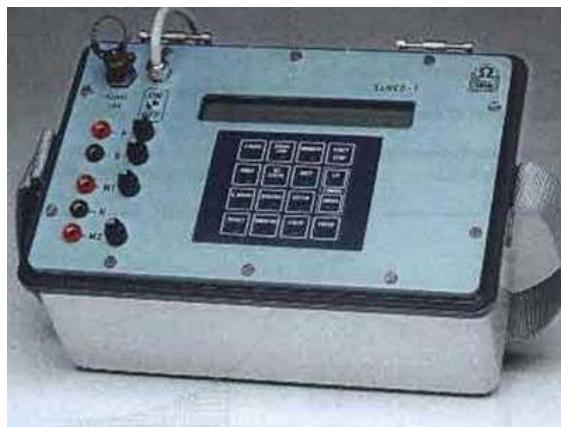
Photo n°1 : Matériel de prospection électrique SYSCAL R2 et ses accessoires
