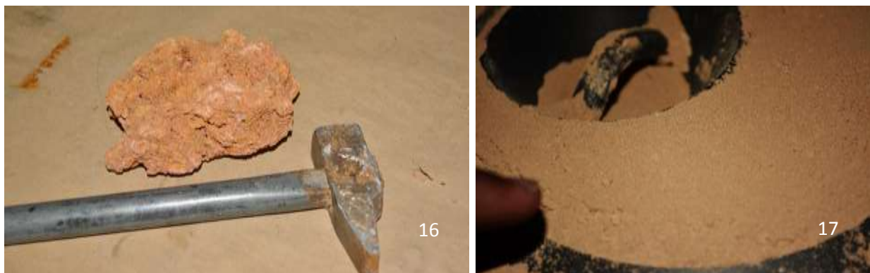
Figure 16 et 17 : Echantillon avant concassage (16) ; Echantillon à 80\mu (17)
