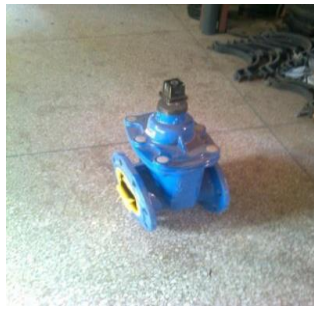
Figure 5: Vanne de sectionnement
