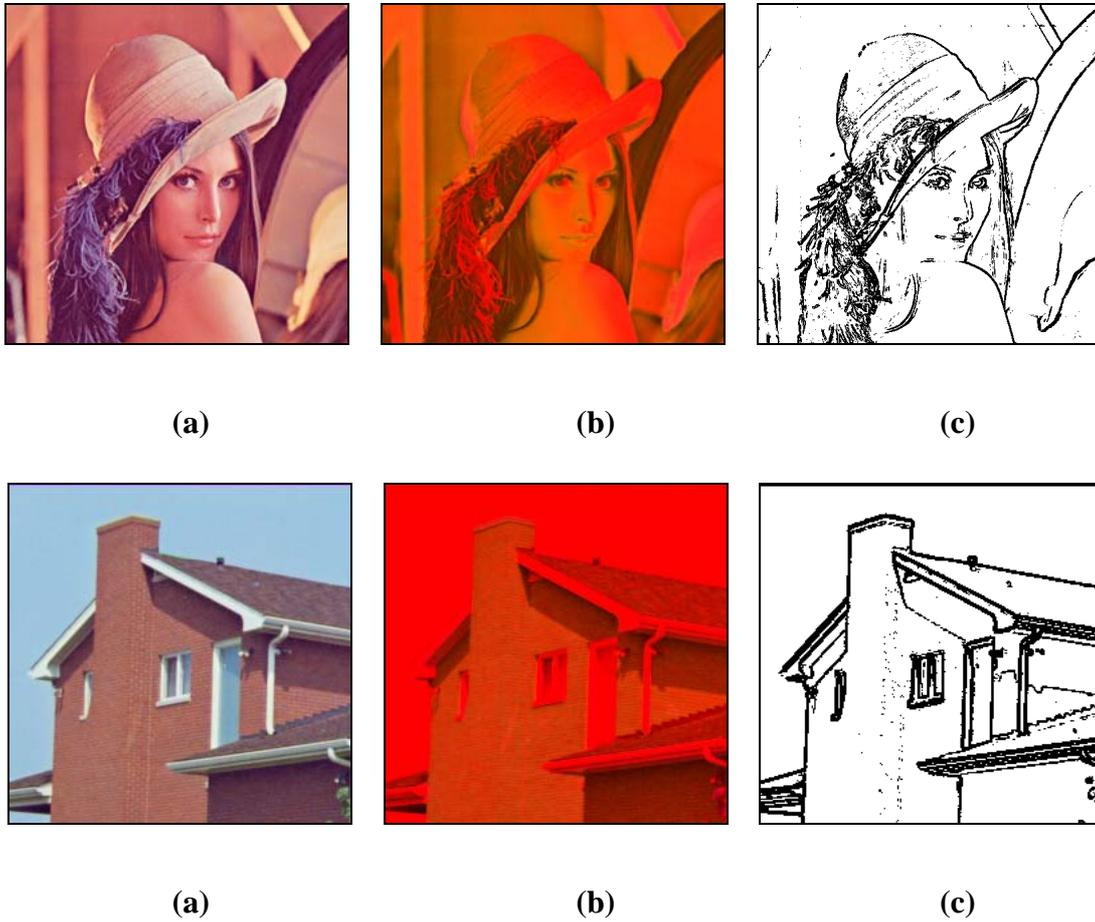
Figure 2.6 (a) Originale, (b) Valeur de la projection (c) Contour en utilisant le filtre de Canny
