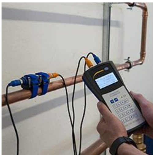
Figure 5 : Débitmètre à ultrason en mesure sur une tuyauterie ; modèle PCE-TDS 100, Source : PCE Instruments
