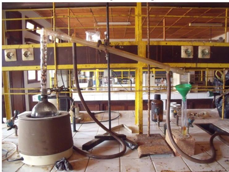
Figure 7: Photo installation de distillation huile usagée (Laboratoire Vontovorona)
