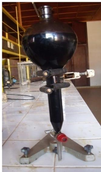
Figure 6: Photo décantation huile usagée (Laboratoire Vontovorona)
