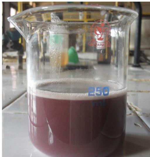
Figure 10 : Photo de l'huile neutralisée avec la chaux (Laboratoire Vontovorona)
