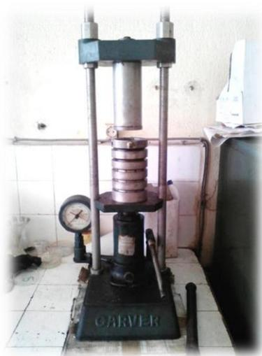
Figure 12 : Presse hydraulique.
