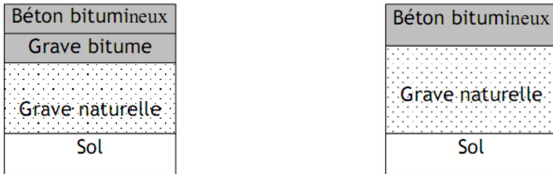
**Figure 17:** Les différentes couches d'une chaussée souple
