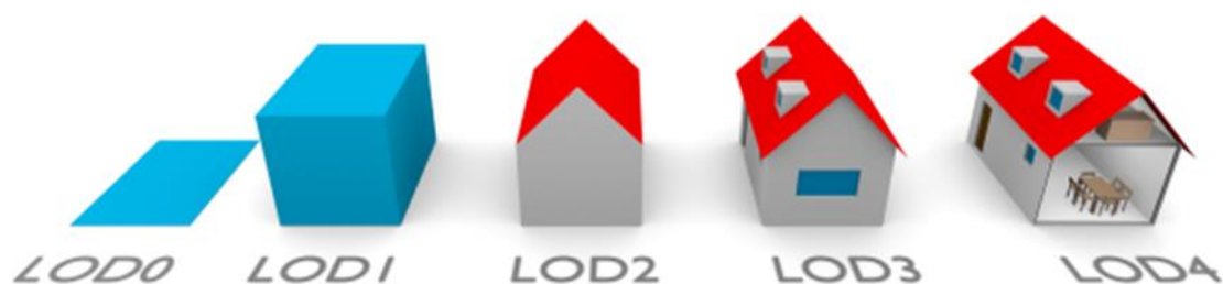
Figure 7 : Représentation d'un bâtiment selon les 5 niveaux de LOD (source : Biljecki, 2016)
