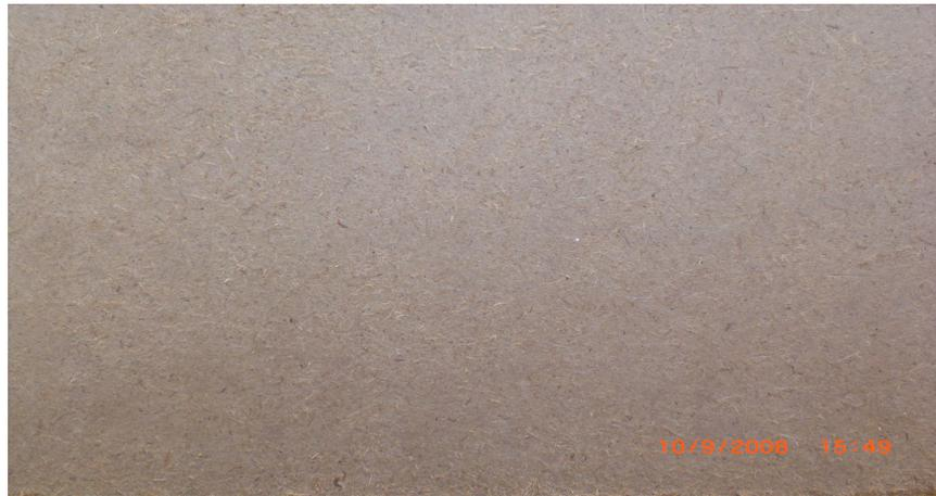
Figure 18(P<sub>3</sub>) : Aspect du produit fini par l'utilisation de 0,7% Ca(OH)<sub>2</sub> + 1,74% NaOH
