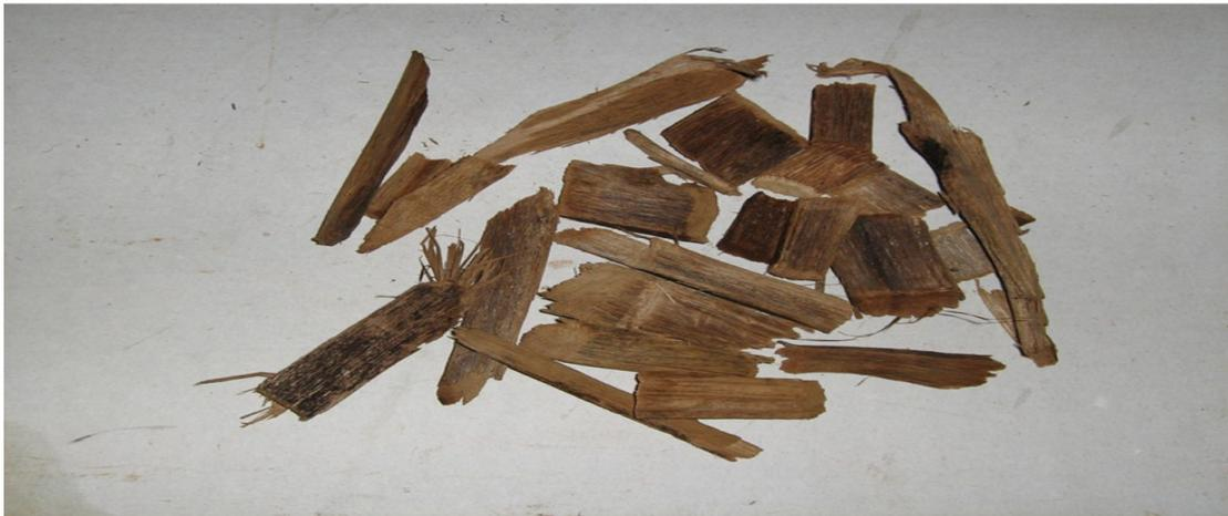
*Figure 13 : Aspect des copeaux cuits par l'utilisation de 0,7%  $\text{Ca}(\text{OH})_2$  + 1,74% NaOH*
