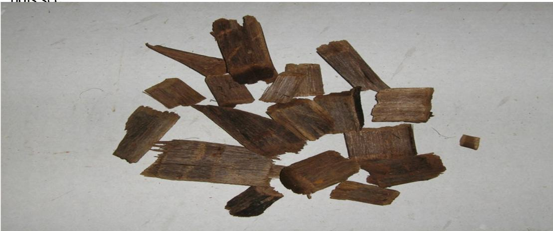
*Figure 14 : Aspect des copeaux cuits par l'utilisation de 0,7%  $\text{Ca}(\text{OH})_2$  + 1,18% NaOH*
