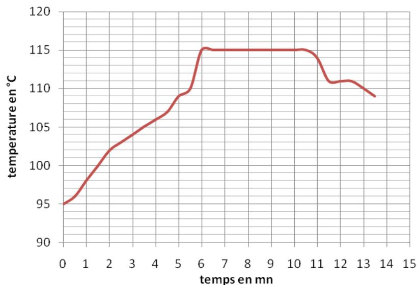
Figure 11 : Température de cuisson dans la cocotte minute.
