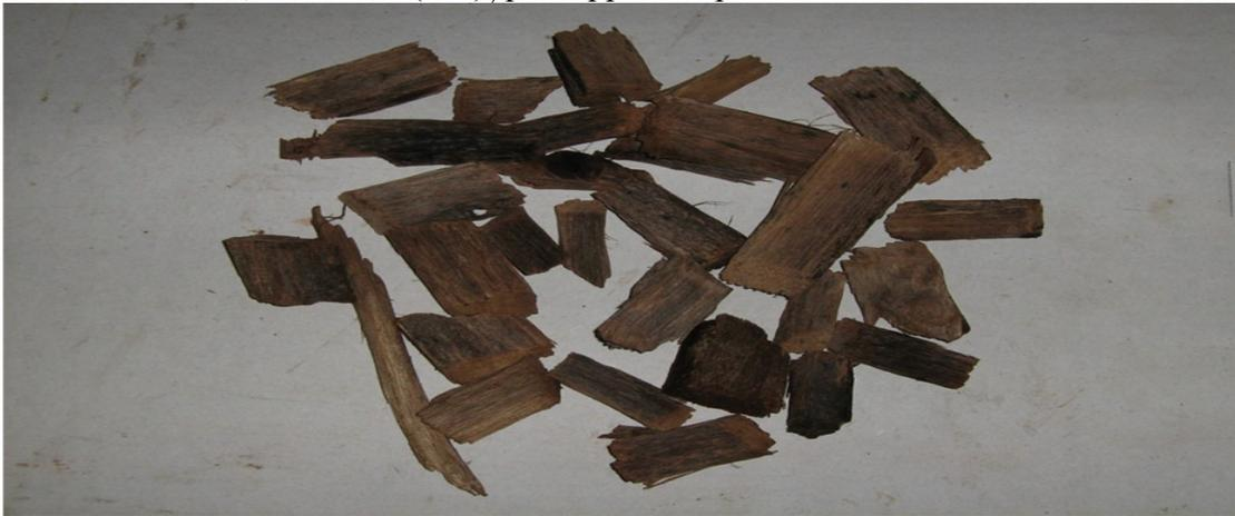
*Figure 12 : Aspect des copeaux cuits par l'utilisation de 1,49%  $\text{Ca}(\text{OH})_2$*
