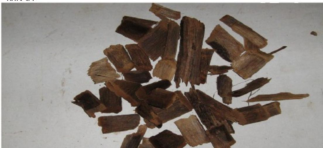
Figure 15 : Aspect des copeaux cuits par l'utilisation de 0,7%.  $\text{Ca}(\text{OH})_2$  + 0,88% NaOH
