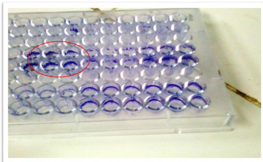
**Figure 9 : Biofilm formé sur toute la surface du puits**
