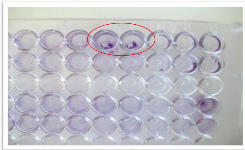
**Figure 8 : Biofilm formé sur la paroi et le fond du tube**
