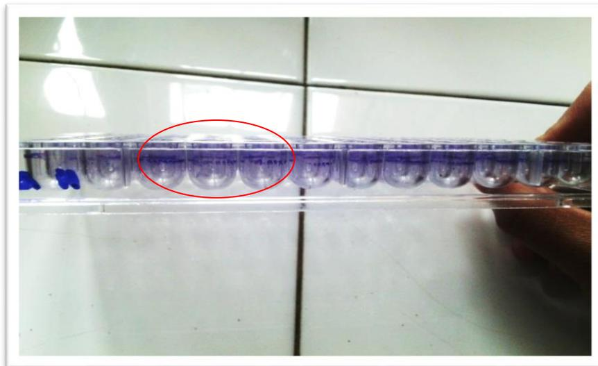
**Figure 7 : Biofilm formé sur la paroi de la plaque**
