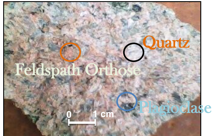
Photo 5: Echantillon n° VBE-VI : Ortholeptynites à grenat
