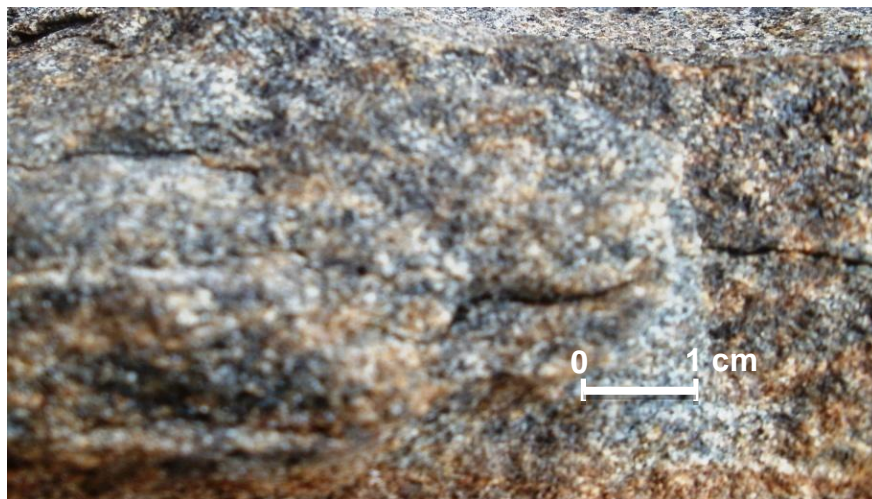
Photo 2: Echantillon n° VBE-I : Gneiss à grain fin
