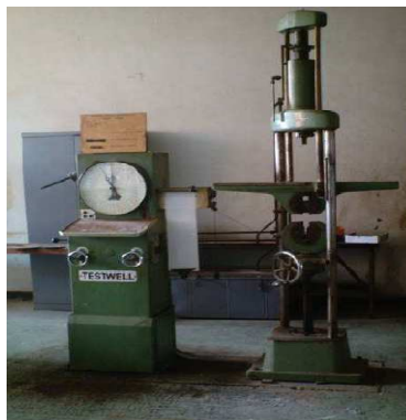
Photo 11 : Presse hydraulique TESTWELL multifonctionnelle permettant le compactage et le test de la résistance à la compression (Bloc Technique Ankatso)
