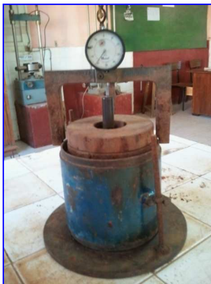
Photo 7 : moule chargé de latérite avant saturation dans le bac à imbibition
