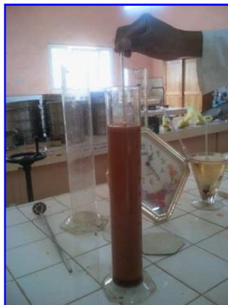
Photo 2 : Mise œuvre de l'analyse granulométrique par sédimentation
