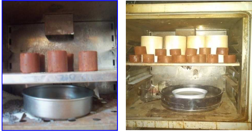
Photo 14 : Séchage sous atmosphère contrôlée des éprouvettes
