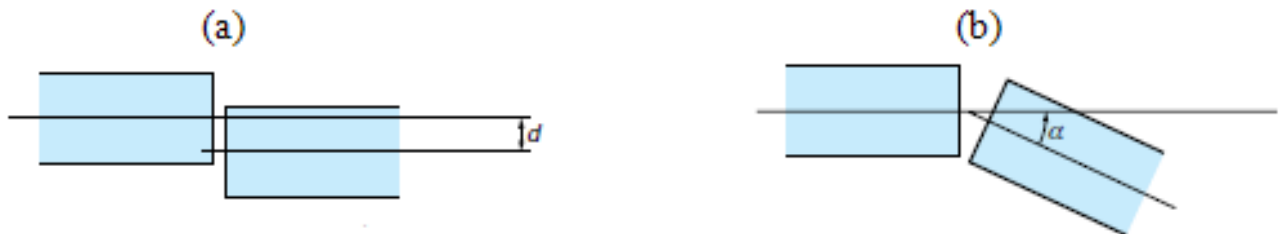
Figure 3.07 : a) Désalignement axial b) Désalignement angulaire
