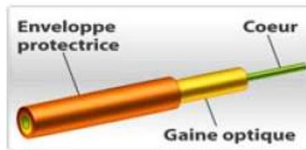
Figure 1.02 : Structure d'une fibre optique
