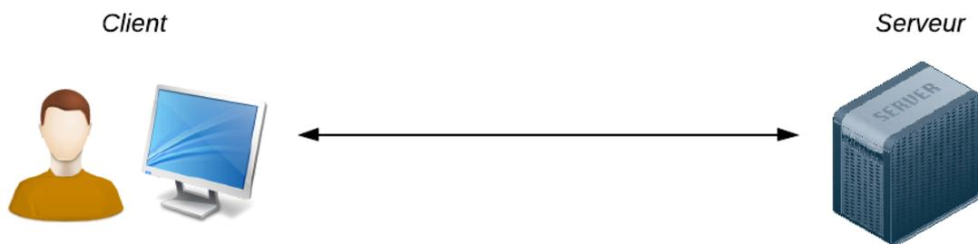
**Figure 2.11 :** *Communication synchrone avec websocket: un tuyau de communication reste ouvert entre client et serveur*
