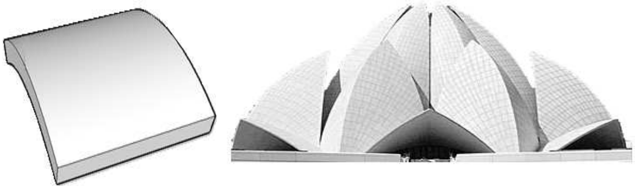
Figure 14 : coques et voiles
