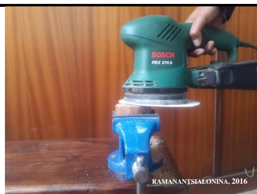
Photo 1 : Ponçage de la micro-carotte
