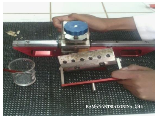
Photo 8: Confection des coupes au microtome de type G.S.L.
