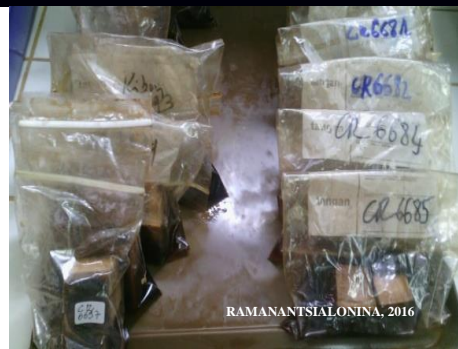
Photo 6 : Blocs conservés dans de l'alcool 30 %
