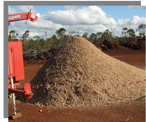
Photo 16: Broyage avant fermentation du compost
