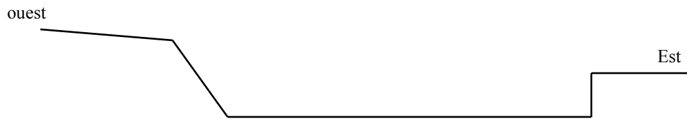
Fig. 6 : Coupe simplifiée d'une exploitation en gradins successifs
